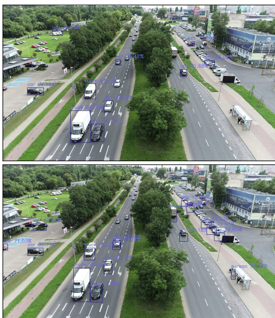
Rysunek 5.11. Porównanie różnic rozpoznawania obiektów algorytmów wykorzystujących sieci neuronowe, na przykładzie pojedynczej klatki wideo zarejestrowanej na ulicy Mieszka I w Szczecinie. Na górze algorytm ResNet. Na dole algorytm YOLO
